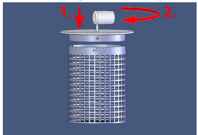
Verriegelung der elektrischen Halterung des Paraffinbechers.
